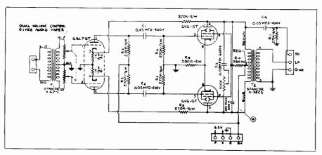
Fig. 25-9. Schematic of cueing amplifier 635-A2.
